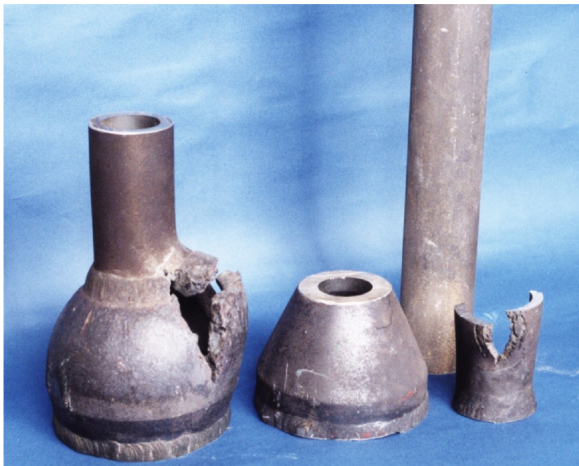
台肥苗栗廠重組爐管高溫破壞，是意外，還是壽命已到？( 課堂教材 )
